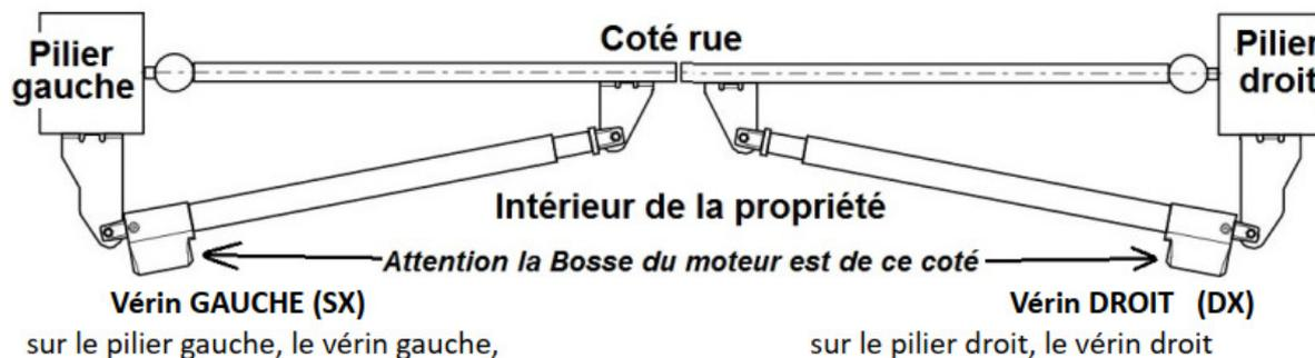
Mesure de la cote vérin replié sur lui-même en enlevant la goupille côté vantail pour être certain de mesurer la bonne dimension.
