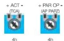
A la fin de l'installation, régler finement les Trimmers (316)
