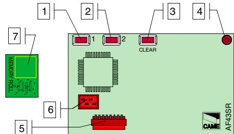
**D Radiofrequenzplatine mit 433,92 MHz**
