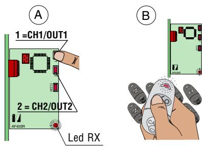
**D** 1 - Eine Taste zum Speichern vom Code 2 Sekunden lang drücken, bis das LED RX zu **blinken** anfängt (Abb. A).
