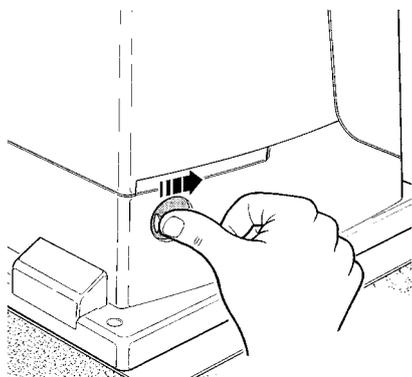
2 Introduire la clé et la tourner dans le sens des aiguilles d'une montre
