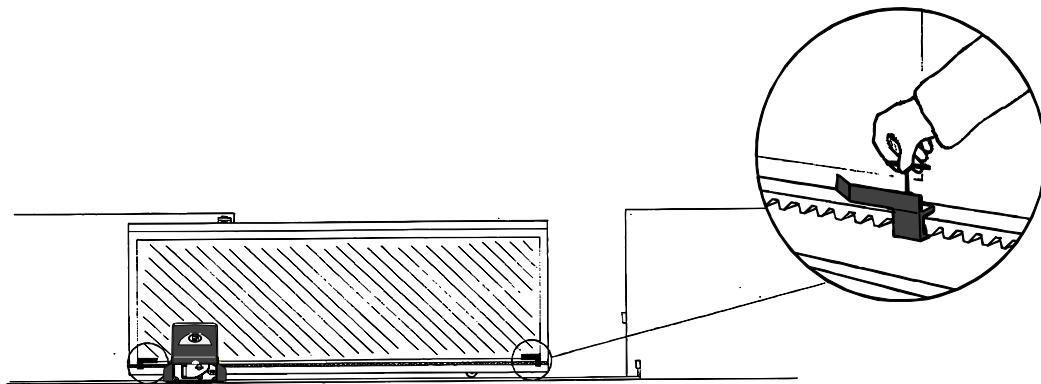
**Posizionare sulla cremagliera le alette finecorsa che determinano, con la loro posizione, la misura della corsa.**
