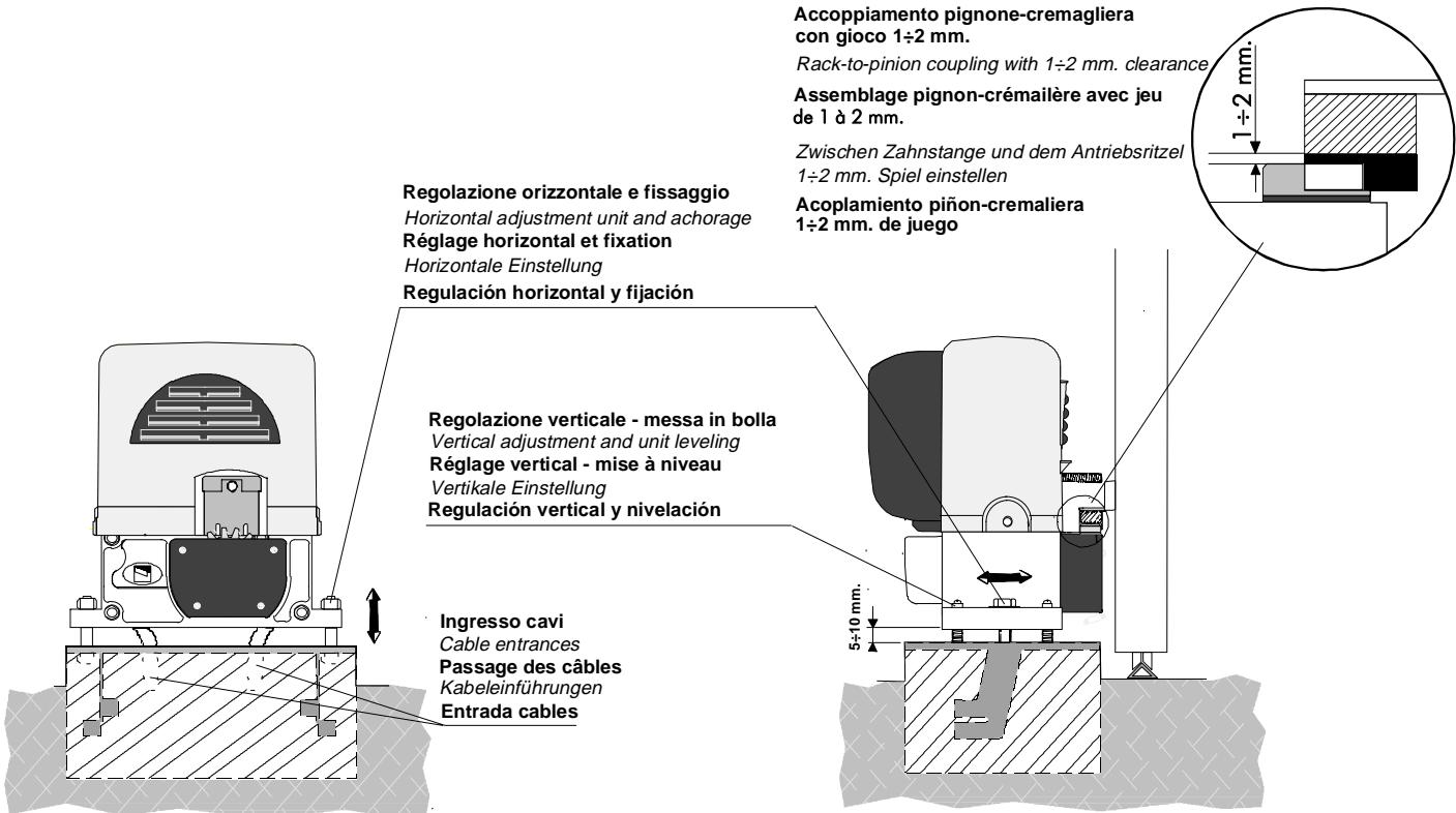
Nella fase preliminare di posa, i piedini dovranno sporgere di 5-10 mm. per permettere allineamenti, fissaggio della cremagliera e regolazioni successive.
