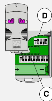
impostare il codice sul dip-switch C e il canale su D (P1=CH1 e P2=CH2, impostazione di default)
