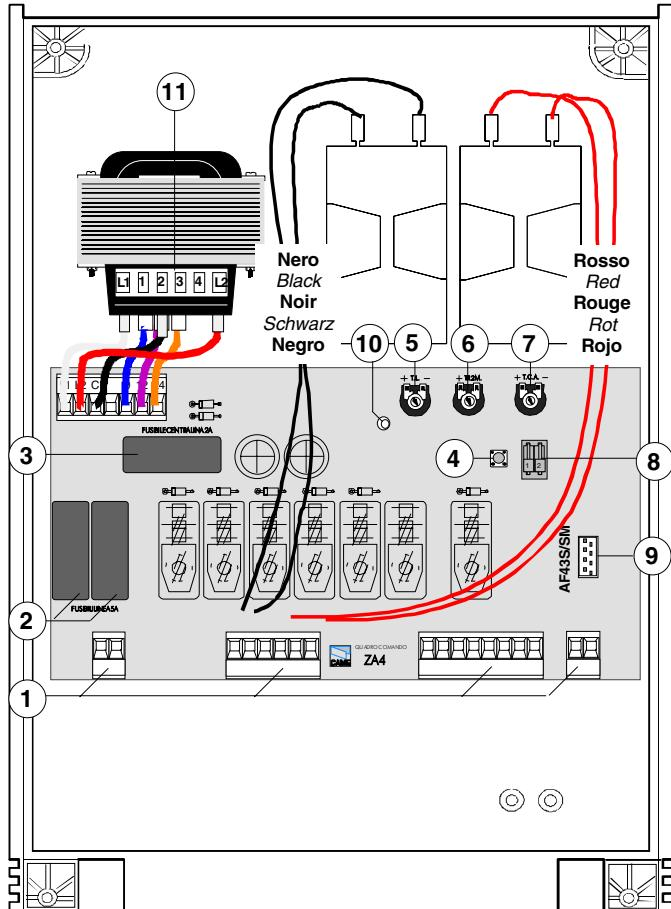
**Nota: serie FROG,** collegare i fili neri che fuoriescono dalla scheda sui connettori del condensatore del 1° motore e i fili rossi sul condensatore del 2° motore.
