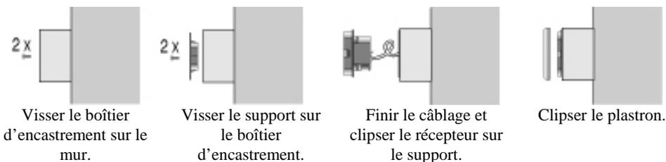
Visser le boîtier d'encastrement sur le mur.
